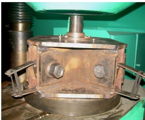
Рис. 2. Мультиштамп для моделирования процесса выдавливания стружечных канавок метчиков радиальным обжатием
